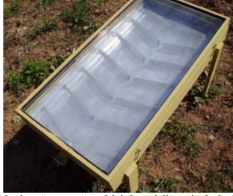
Resim 4.7: Peteklerin güneş ışığı etkisiyle eritilmesinde kullanılan camedân
