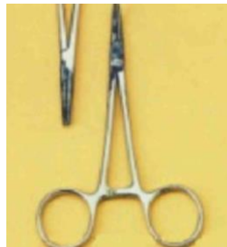
Resim 1.5: Kan ve doku artıklarının aletler üzerinde oluşturduğu korozyon
